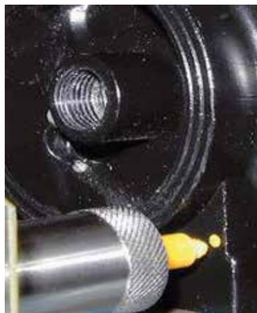
Sistemi di marcatura tramite bollinatura
