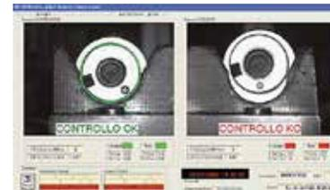
Controllo posizionamento albero motore
