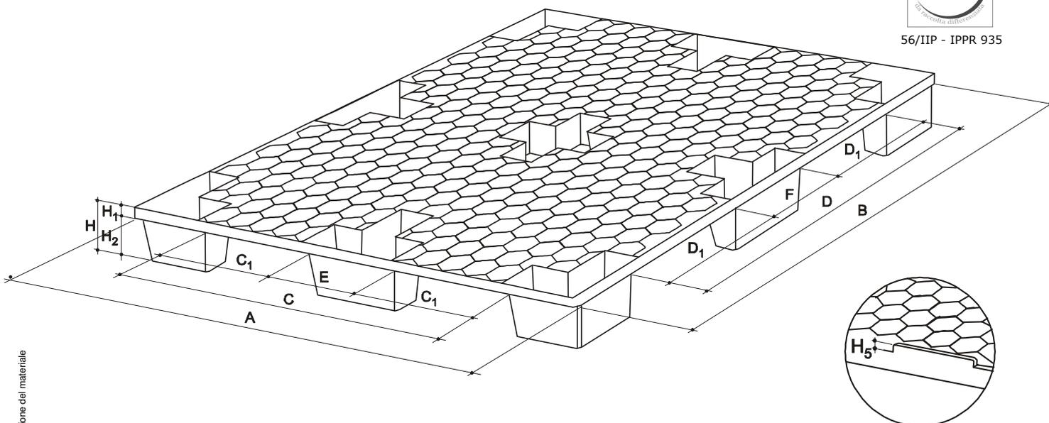
Nella versione con bordino di contenimento:  $H_5 = 8$  mm
