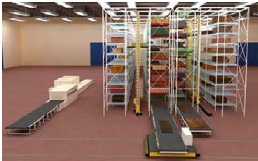
Il magazzino intensivo M1 rappresenta la soluzione ideale per lo stoccaggio automatico dei pannelli. Il sistema trova applicazione in quei contesti operativi in cui i moderni centri di lavoro richiedono un'elevata movimentazione dei semilavorati. In particolare, il nuovo sistema M1 è apprezzato in quei processi produttivi in cui la metodologia operativa del "lotto uno" ha portato alla richiesta di sistemi di stoccaggio speciali e particolarmente performanti.
