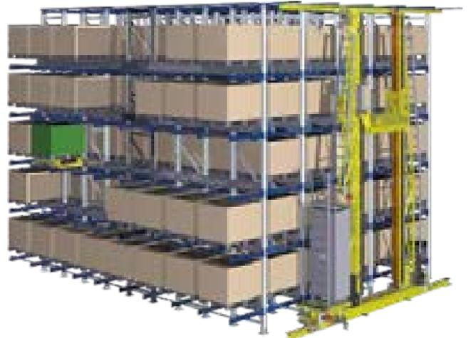
I satelliti iSAT di CASSIOLI possono operare in differenti configurazioni di utilizzo e con logiche di stoccaggio diverse. Per poter essere depositato, il pallet è collocato per mezzo di un carrello elevatore o di un trasloelevatore ad un'estremità del canale. Da quella posizione viene prelevato dal satellite e trasportato automaticamente lungo il canale fino a raggiungere la propria postazione.
