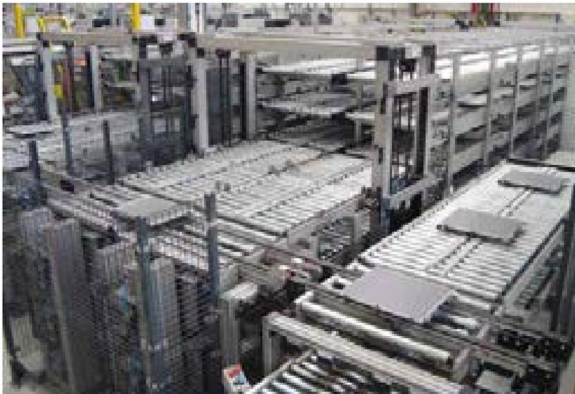
**Linee a cadenza costante.** Classico sistema di trasporto a rulli, a nastro, a catena, a cinghia, a tapparelle per un'alimentazione costante delle stazioni operative.
