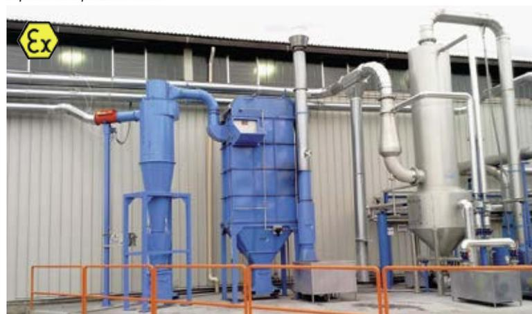
Filtrazione polveri di acciaio con antidet-dumper e abbattimento ad umido polveri di alluminio
