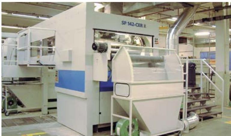
Aspirazione di cartoncino teso-microonda e ondulato
