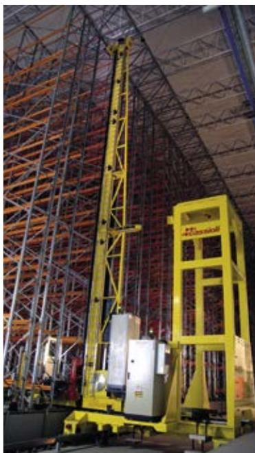
Magazzino con trasloelevatore
