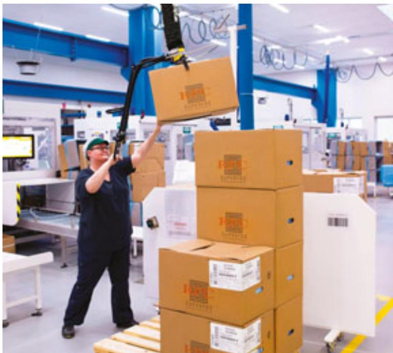
Manipolatore a vuoto multifunzionale per sollevamento al di sopra delle spalle
