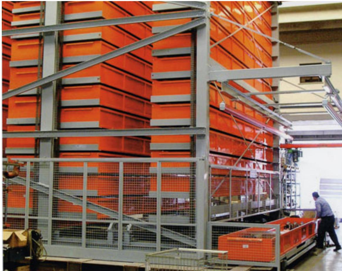
Magazzino per componenti pesanti (3000 kg per contenitore)
