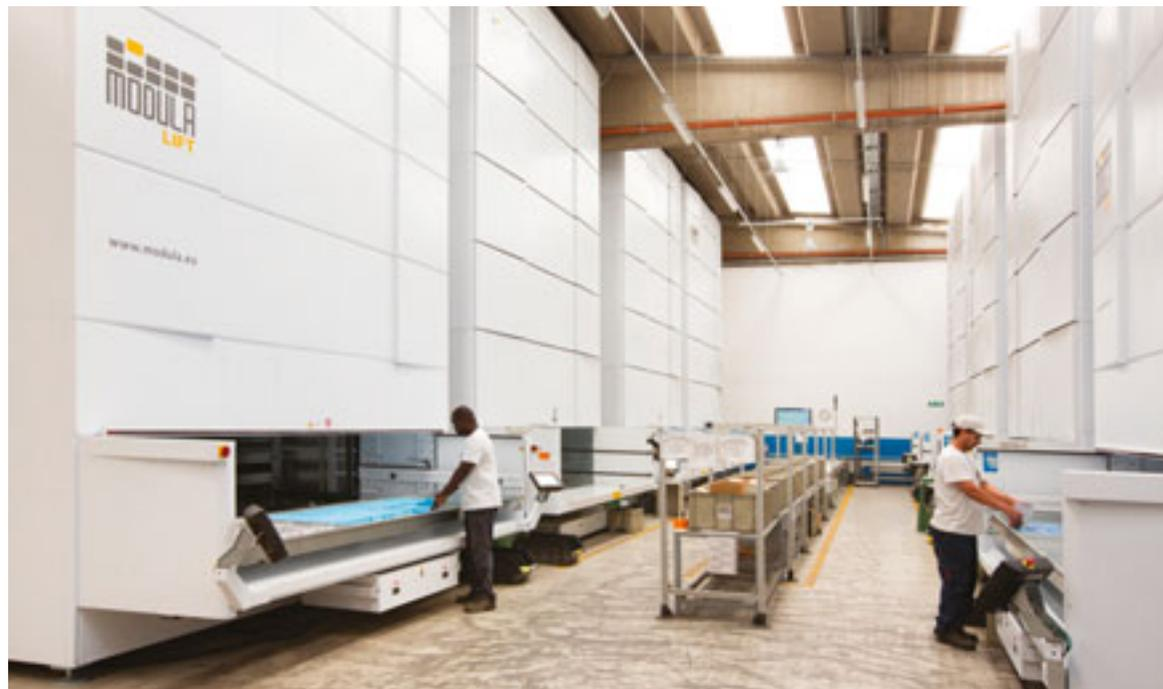
Magazzini verticali automatici Lift con operatori alle baie di carico
