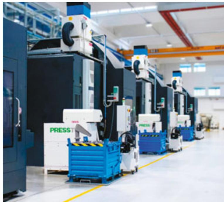
Compattatori PRESSTO sulle linee di produzione OMCR
