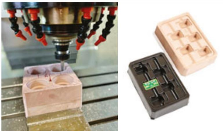
Realizzazione di prototipi per imballi avvolgenti termoformati
