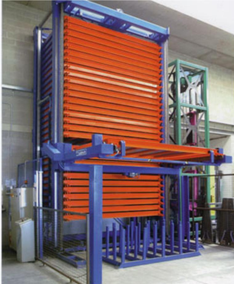
Magazzino automatico per lamiere formato 1500 x 3000 mm
