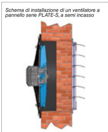
*Schema di installazione di un ventilatore a pannello serie PLATE-S, a semi incasso*
