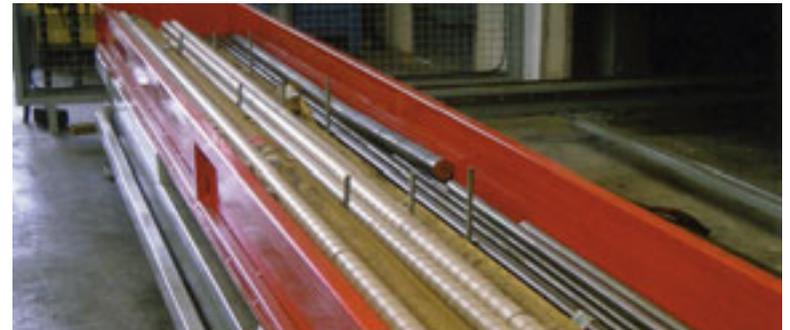
Contenitore con separatori per stoccaggio tondi in acciaio
