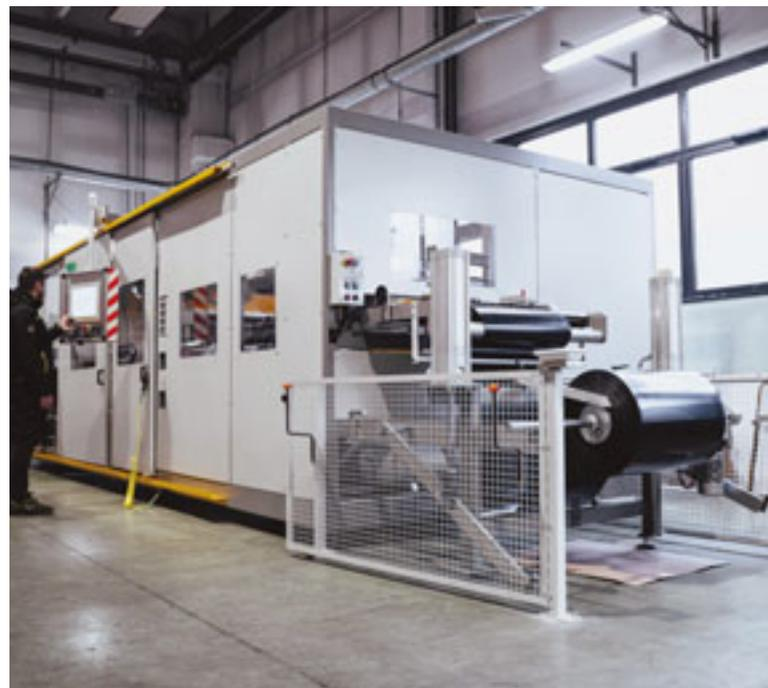
Impianto di produzione con termoformatura a ciclo automatico
