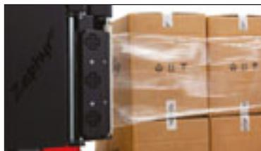
Zephyr è il nuovo sistema PKG di aggancio e taglio film in automatico che sfrutta l'utilizzo dell'aria per l'applicazione del film senza necessità dell'operatore
