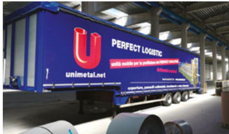
Unità mobile per la profilatura in cantiere
