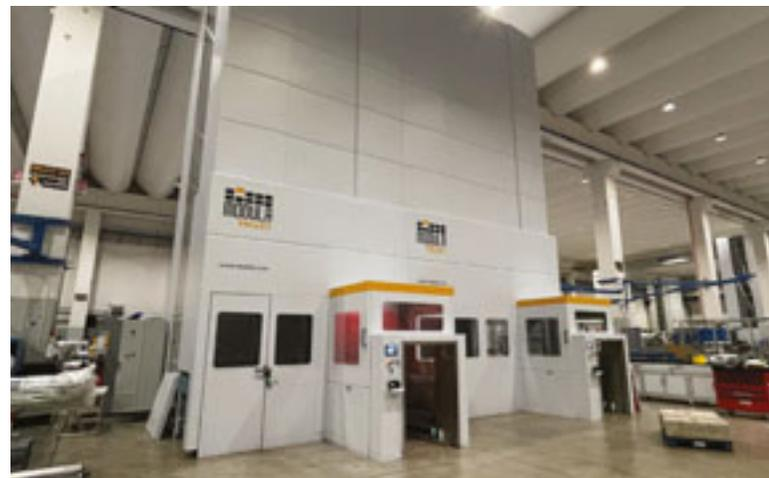
Magazzini verticali automatizzati Modula Pallet con accesso transpallet
