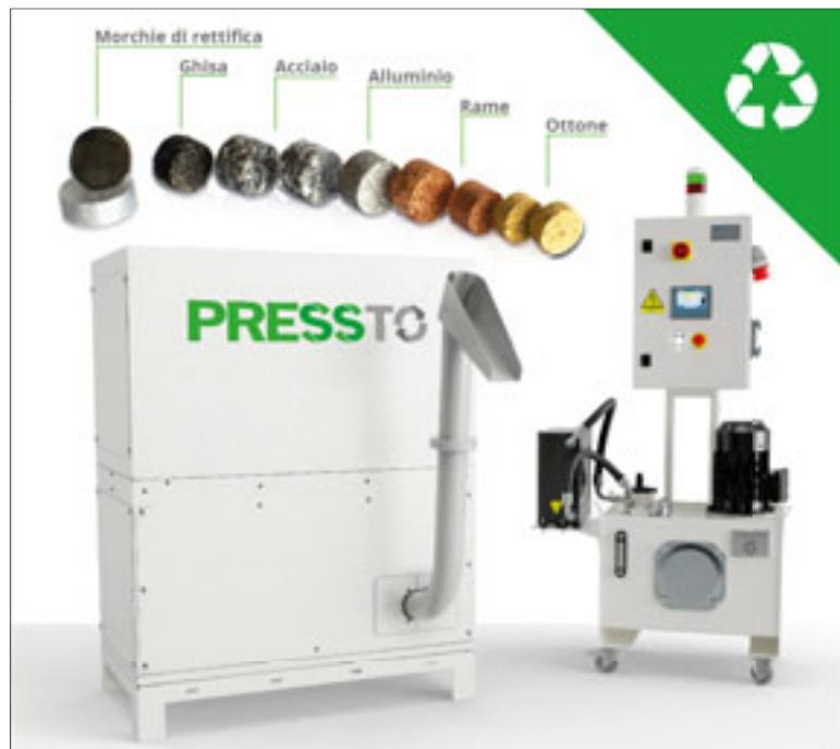
Compattatore PRESSTO e bricchetti ottenuti dalla lavorazione di trucioli metallici
