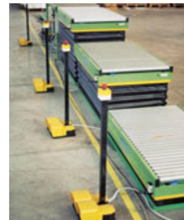
Linee montaggio a rulli con piattaforme elevatorie
