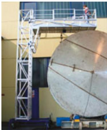
Scale e piattaforme per saldatura di virole e boiler
