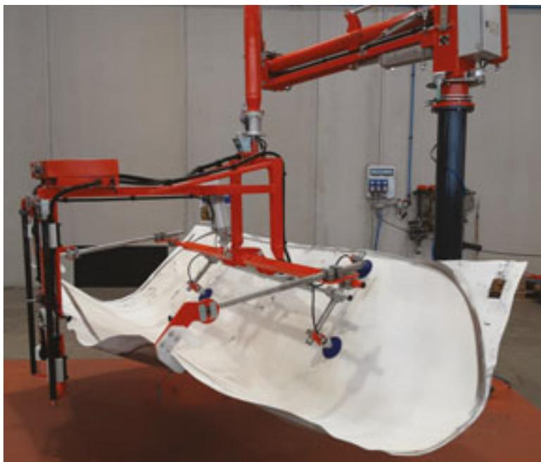
Movimentazione di lamiere conformate automobile
